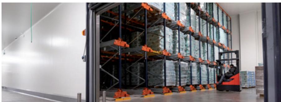
« Le fonctionnement du Pallet Shuttle se distingue par sa simplicité », indique Dan Bellaïche. La navette automatique est chargée de déplacer la charge jusqu'au premier emplacement libre dans le canal. Tandis que le Pallet Shuttle transporte et dépose la palette, l'opérateur met une autre palette à la première position du même canal. Ainsi, lorsque le Pallet Shuttle revient à sa position de départ, il peut répéter le même mouvement successivement.
