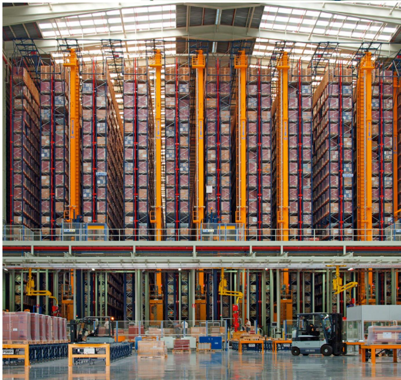
Les transstockeurs, équipés d'un récupérateur d'énergie, sont capables de recueillir et de renvoyer au réseau électrique environ 15 % de l'énergie générée pendant les manœuvres de descente de la nacelle et de décélération de l'axe de déplacement.
