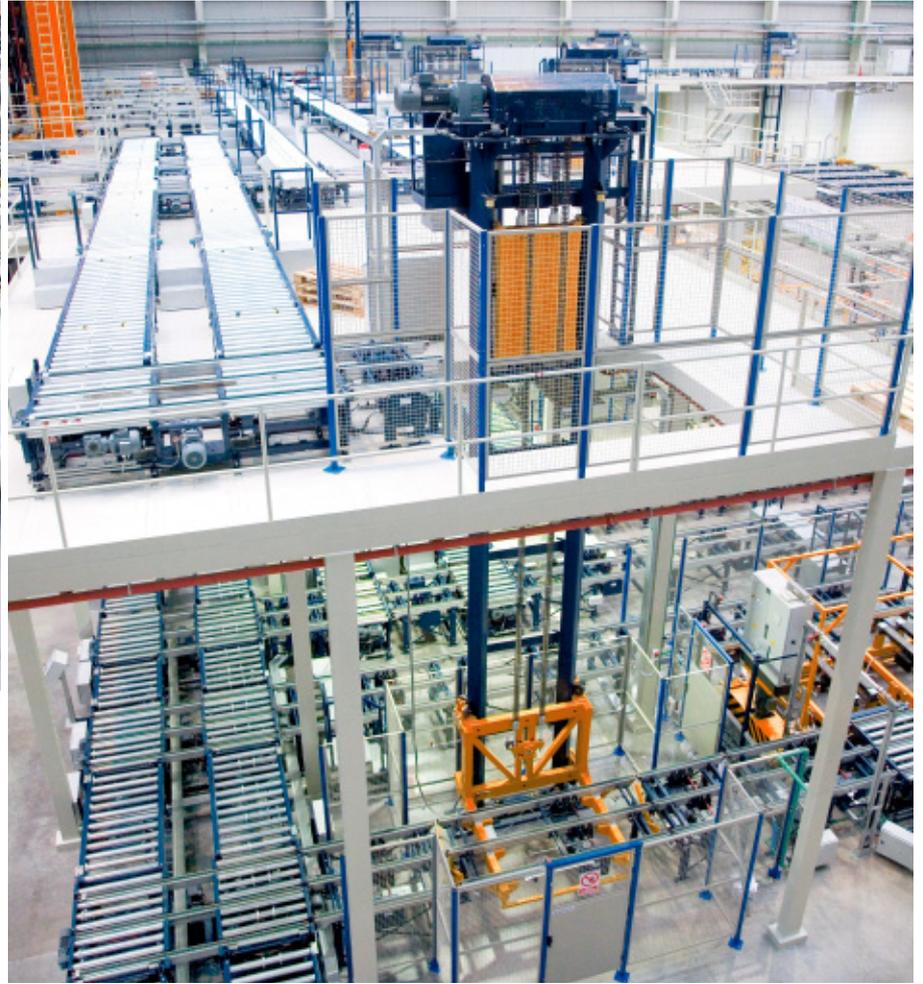
En plus des postes de picking, une zone indépendante située perpendiculairement aux allées où sont stockés les produits de grandes dimensions, a été aménagée pour préparer les commandes contenant ce type de produits spécifiques. Les convoyeurs et la navette se chargent de relier l'entrepôt avec les postes de picking.
