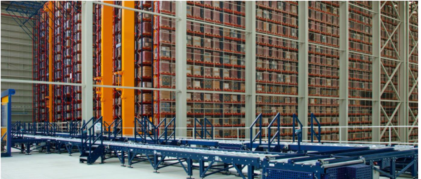
À l'étage supérieur, a été installé le circuit de convoyeurs d'entrée dans l'entrepôt. Il intègre une recirculation pour distribuer facilement les palettes sur une ligne en cas de problème. En même temps, il communique avec les autres élévateurs qui montent les palettes provenant de la zone de picking et des entrées auxiliaires.
