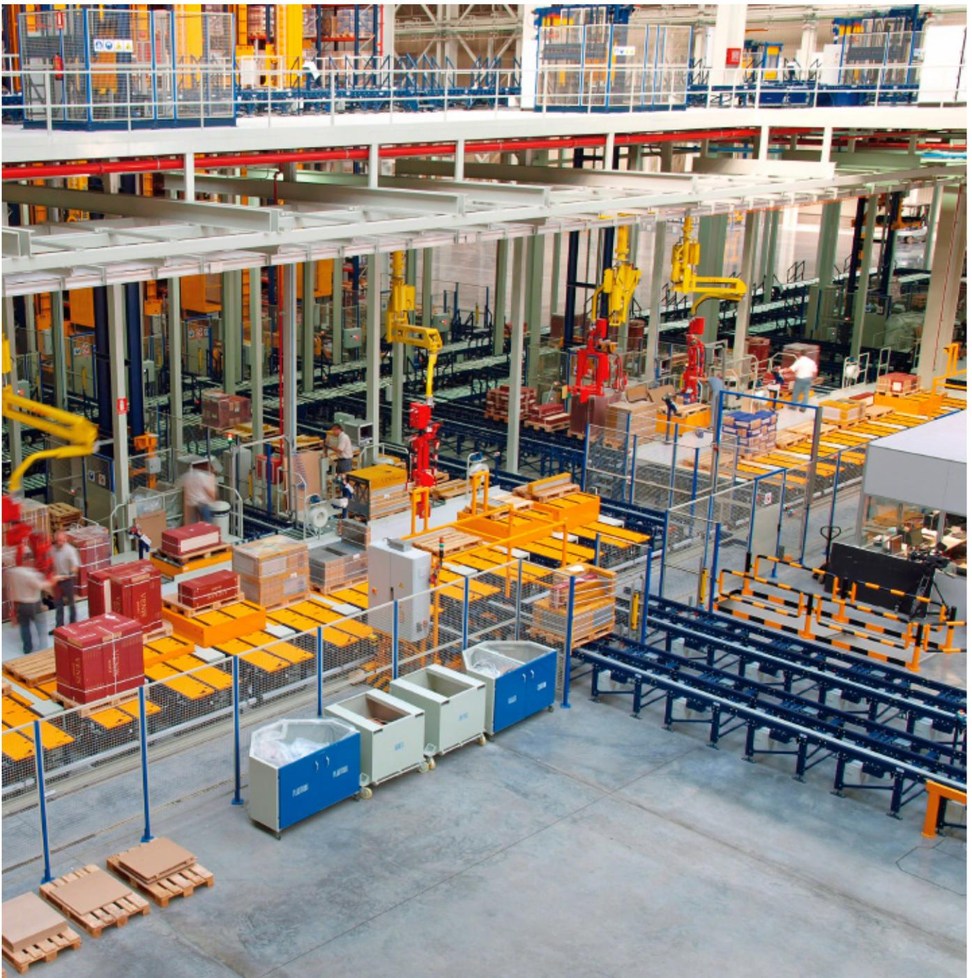
Pour faciliter les manœuvres des opérateurs, chaque poste dispose d'un bras mécanique qui soulève les paquets les plus lourds avec un minimum d'efforts.
