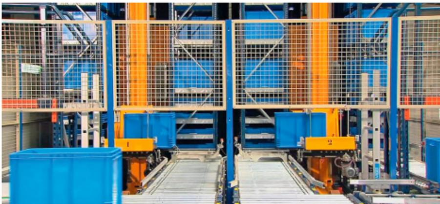
Dans chacune des allées circule un transstockeur effectuant automatiquement les entrées et les sorties de la marchandise. Dans la partie frontale de l'entrepôt, il y a un circuit de convoyeurs qui relie les allées de stockage à deux postes de picking et à un poste de réapprovisionnement.
