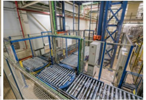
Les élévateurs, qui peuvent transporter deux palettes simultanément (l'une derrière l'autre), sont capables d'absorber le grand nombre de livraisons provenant du centre de production dans un laps de temps relativement court
