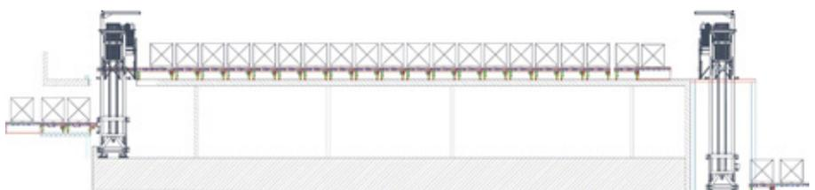
Le début comme la fin du pont se trouvant à une hauteur élevée, un élévateur transporte les palettes jusqu'au niveau des convoyeurs
